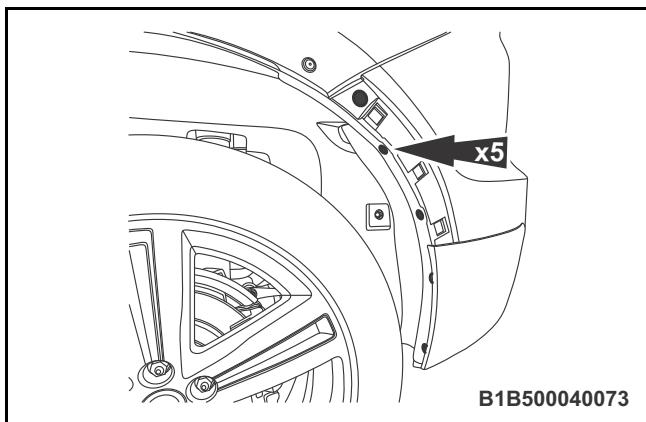
◆5. 拆卸左后挡泥板的 3 个塑料子母扣。
