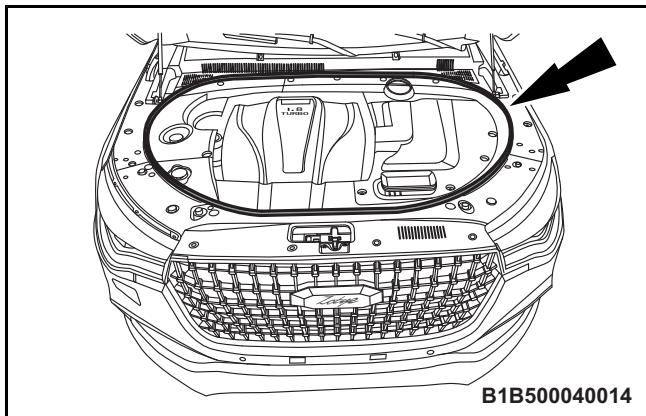
◀ 3. 拆卸发动机密封条总成。
