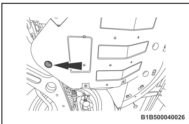
◀8. 拆卸发动机下护板本体后端的 1 个固定螺栓。
