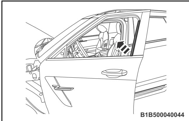
4. 拆卸左前门 B 柱外装饰板总成的 3 个固定螺钉，取下左前门 B 柱外装饰板总成。
