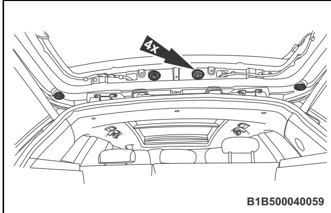
4. 拆卸扰流板的 4 个固定螺母。
