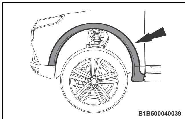
◀ 3. 拆卸左前轮眉一圈的卡扣，取下左前轮眉总成。
