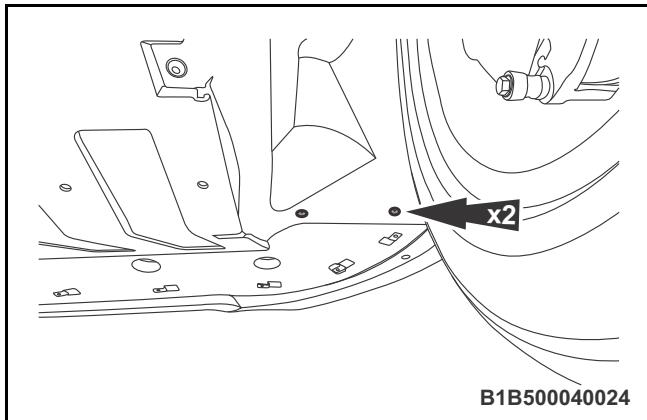
◀6. 拆卸发动机下护板与右前轮挡泥板连接的 2 个固定螺钉。
