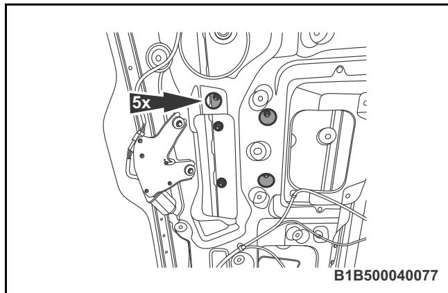
◆4. 脱开后背门外饰件总成与后背门卡扣的连接。
