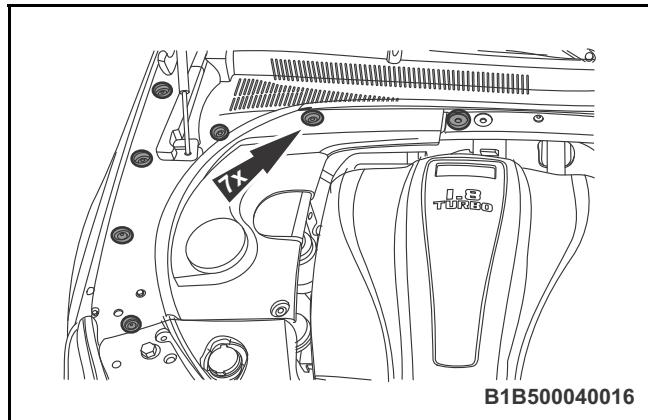
◆ 15. 拆卸发动机右侧盖板的 7 个螺纹子母扣，取下右侧盖板。
