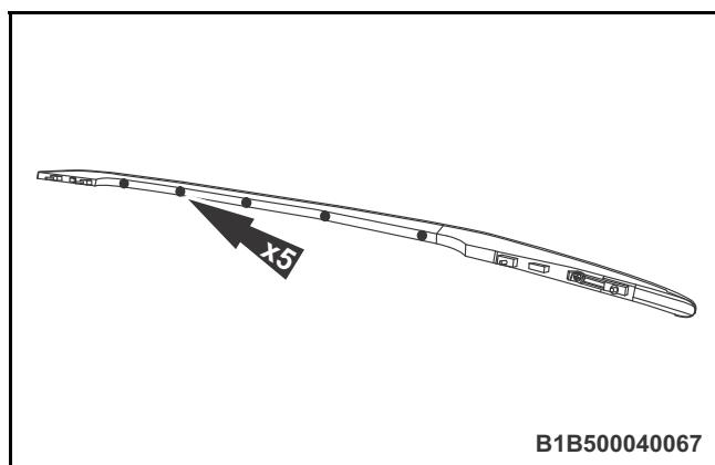
◆4. 拆卸左行李架中端盖的 5 个固定螺钉。
