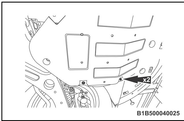
◀7. 拆卸发动机下护板本体后端的 2 个固定螺钉。
