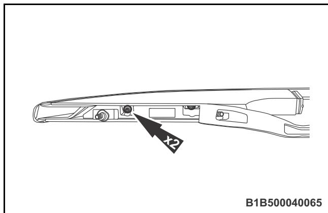
◀4. 拆卸左行李架后端盖的 2 个固定螺钉
