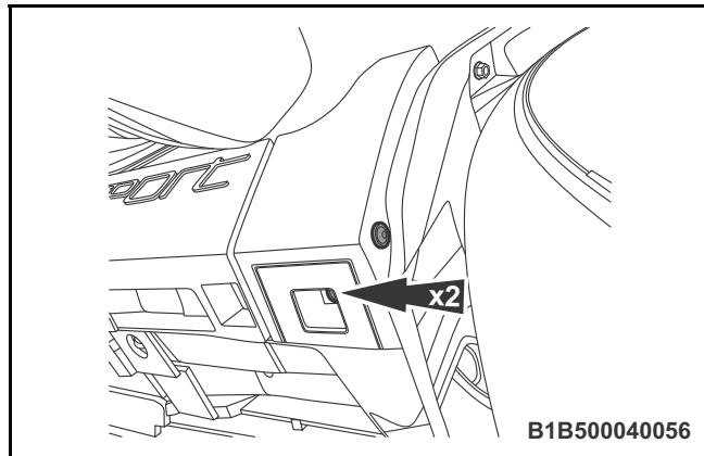
►11. 拆卸左后轮眉总成的 2 个固定螺钉。
