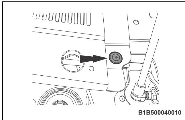
◆6. 拆卸空气室外板总成中间 1 个螺纹卡扣。
