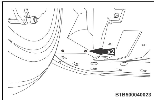
◆ 3. 拆卸发动机下护板本体前端的 6 个固定螺钉。
