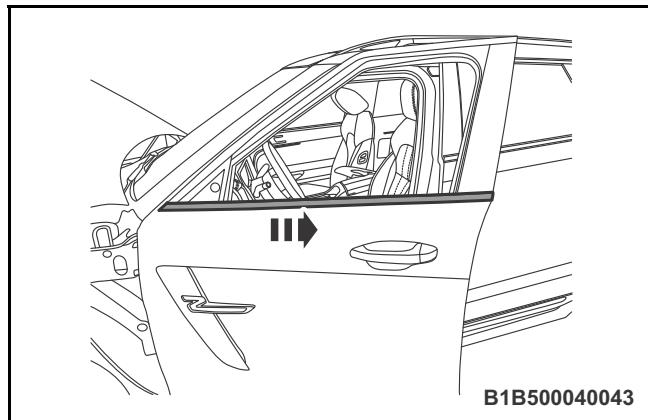
◀ 2. 按图中方向拆卸左前门外水切总成。
