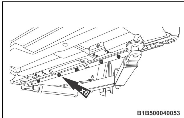
4. 拆卸左侧围下饰板总成的 6 个固定螺钉。
