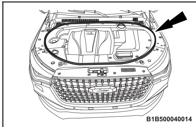
12. 拆卸发动机密封条总成。
