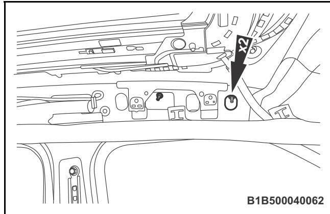
◀12. 拆卸左行李架总成前端的 2 个固定螺母。
