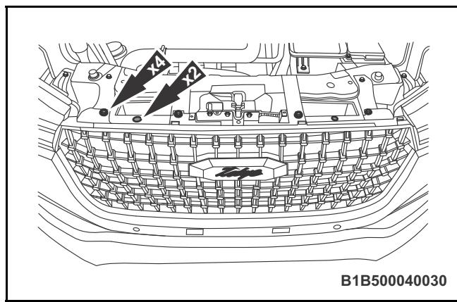
◆ 17. 拆卸散热器格栅总成的 4 个固定螺钉和 2 个螺纹子母扣。
