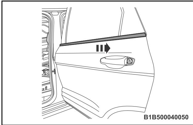
◀1. 按图中方向拆卸左后门外水切总成。
