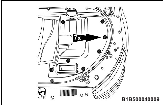
◀ 2. 拆卸空滤盖板的 7 个螺纹子母扣，取下盖板。
