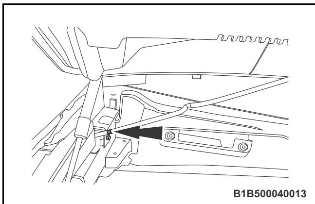
◀8. 断开空气室外板总成与前洗涤管路总成的连接。
