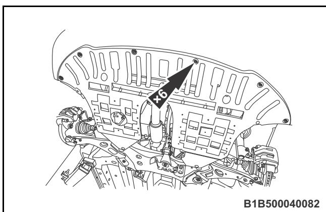
◀4. 拆卸发动机下护罩与前副车架的 2 个螺栓。
