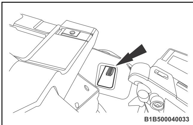
◀ 5. 脱开散热器右导风板与散热器上导风板的连接。
