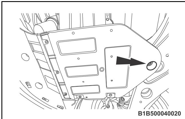
◀ 3. 拆卸发动机下护板盖板的 1 个固定螺栓。
